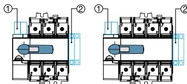
1. Max. 2 x blok pomocných kontaktů typu "U" ( 2 kontakty)
