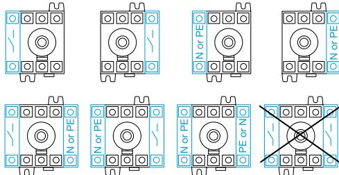
Bloky pomocných kontaktů typ- M pro signalizaci polohy s funkcí „pre-breaking“
