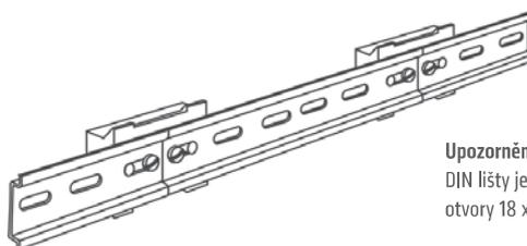
**Upozornění:** V případě použití STEGOFIX jako držáku DIN lišty je možné volit pouze DIN lišty (EN 60715) s otvory 18 x 6,2 mm nebo 18 x 5,2 mm.
