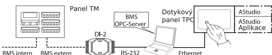
BMS OPS Server je instalován na počítač, který je připojen k systému Bender přes konvertor rozhraní DI-2. Tento OPS server zajišťuje pouze transformaci dat z externí BMS sběrnice systému Bender na OPS údaje. AStudio instalovaný na dotykovém panelu zahrnuje rovněž OPS client a je schopen zpracovat data přicházející z OPS serveru. S grafickým modulem Astudio lze graficky zobrazit specifická data instalace
