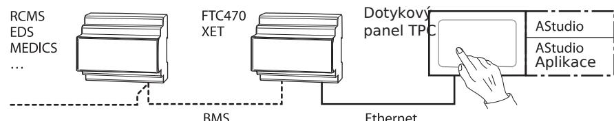
Naměřené hodnoty a hodnoty ALARM jsou přenášeny na interní OPS server, který je konvertuje na vhodné OPS údaje. SW AStudio instalovaný na dotykovém panelu zahrnuje rovněž OPS client a je schopen zpracovat data přicházející z OPS serveru. S grafickým modulem Astudio lze graficky zobrazit specifická data instalace.
