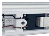
Dva NH lištové pojistkové odpínače QUADRON® 185Power namontované vedle sebe mezi sebou tvoří **průběžný větrací kanál** který odvádí spínací plyny a teplo podobně jako komin.
