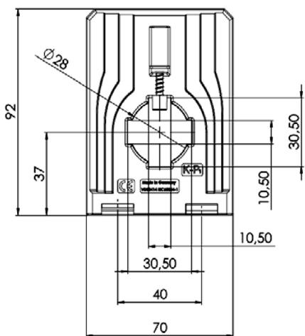
**Proudové transformátory pro měření stejnosměrných I střídavých proudů**
