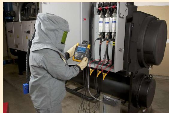
Stačí jen připojit kabely pro měření napětí a ohebné proudové sondy k vedení pro napájení motoru.
